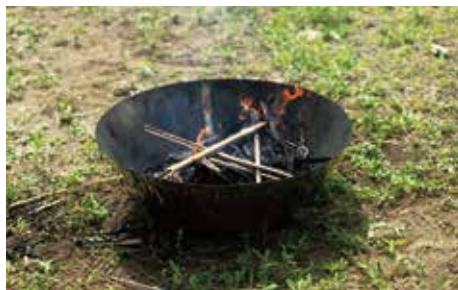
無煙炭化器で炭を製作し、菜園の土中環境を改善し循環させる。
